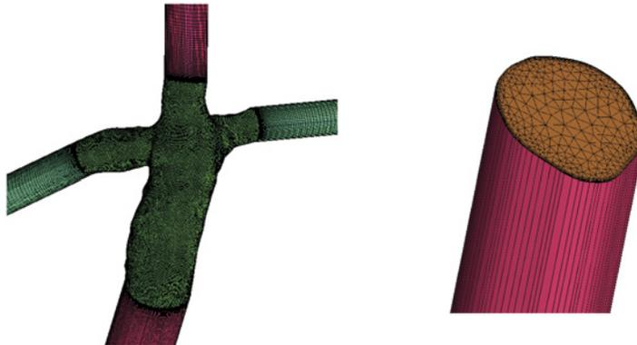
図 4 解析モデルに作成した Mesh とその拡大図
